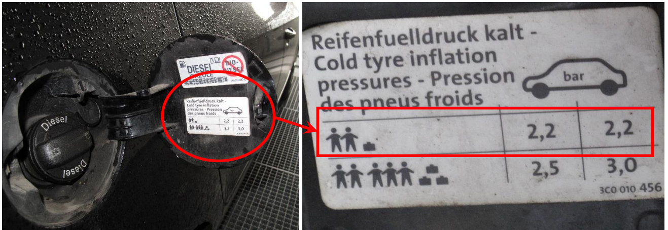
3 pav. Gamintojo numatytas oro slėgis padangose. Atliekant žibintų suregulavimą aukščiau aprašytomis sąlygomis, slėgis padangose turėtų būti tikrinamas vadovaujantis nepilnai pakrauto automobilio duomenimis
